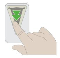
粘着テープの裏紙から三角形のシールを剥がして、モニターの背面にあるシールド開口部の上に貼り付けます。
