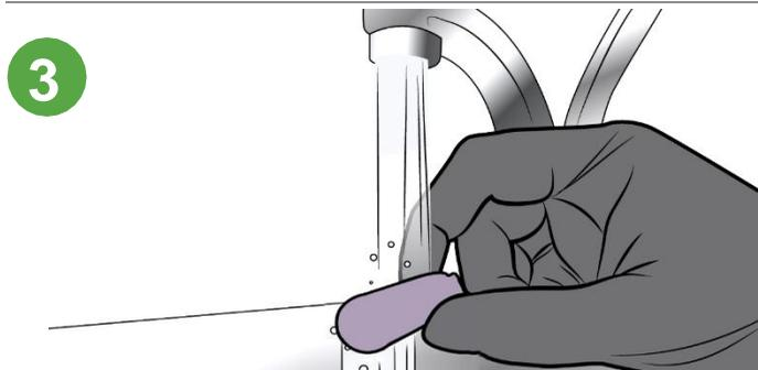
目に見える汚れがすべて落ちるまで、柔らかい毛のブラシでブラッシングしながら、冷たい水道水でトランスミッターをすすぎます。
