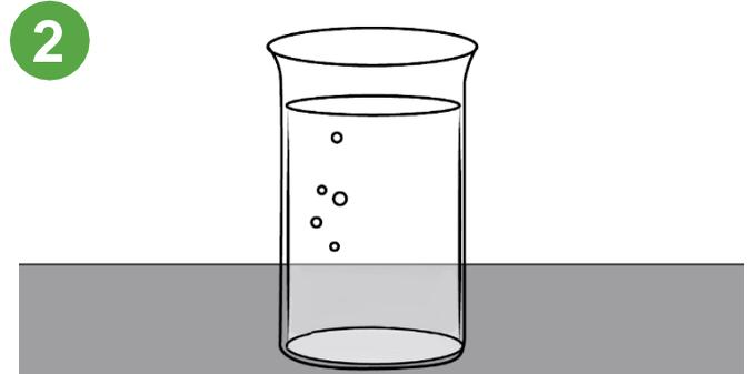
トランスミッターを浸すのに十分な深さの容器に、0.65% 次亜塩素酸ナトリウム溶液を準備します。
