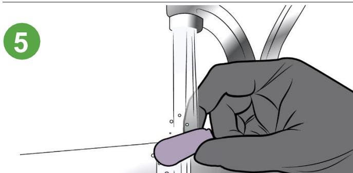
トランスミッターを溶液から取り出し、冷たい水道水を流しながら10秒間すすぎます。
