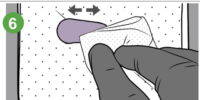
トランスミッターを布で拭いて乾かします。目に見える汚れがないことを確認します。目に見える汚れがあれば、再度洗淨します。
